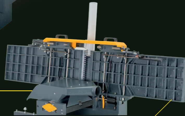
Parallel hinged planing tables Parallelaufklappbare Abrichttische
