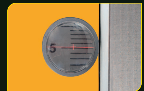
Stock removal indication Anzeige für Spanabnahme
